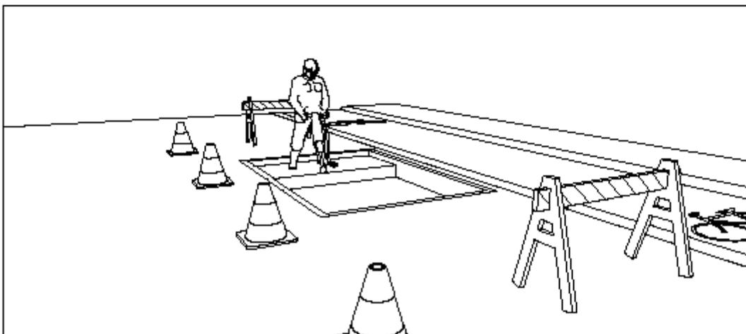
**3º CORTE MECANIZADO:** O serviço consiste requadra em figuras geométricas (retângulo ou quadrado), a área afetada e cortar a capa asfáltica mecanicamente, para que as bordas fiquem perfeitas.
