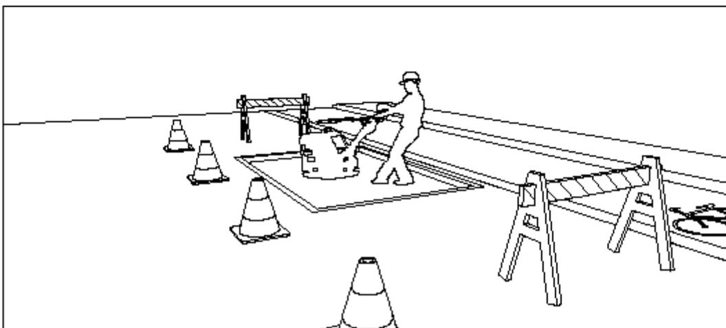
**6º BASE:** De acordo com as Normas Técnicas: NB-1337/91, EB-2096/91 Em todas as intervenções terá a necessidade de melhoria da base, onde será utilizada uma base de bica corrida com classificação A2 (ASTM D3282). Nos serviços de preparação da base, deverá ser feito em camadas de no máximo 20,00 cm, compactados através de compactadores manuais de placa vibratória, progressivamente das bordas para o centro, até atingir o grau de compactação de 95% do PROCTOR MODIFICADO.
