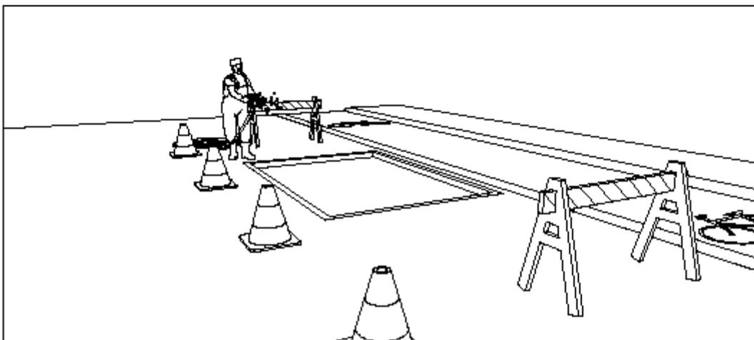
**8º IMPRIMAÇÃO:** Impermeabilização com a aplicação de uma película de material betuminoso sobre uma superfície granular concluída de uma das camadas do pavimento. Cura média, CM-30. O material betuminoso não deve ser distribuído quando a temperatura ambiente estiver abaixo dos 10°C, ou em dias chuvosos, ou quando esta estiver eminente. Qualquer falha na aplicação do material betuminoso deve ser imediatamente corrigida.
